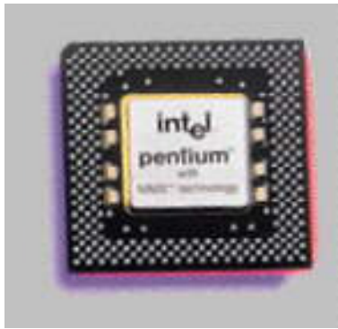
Abbildung 18: Central Processing Unit (CPU) eines Computers
