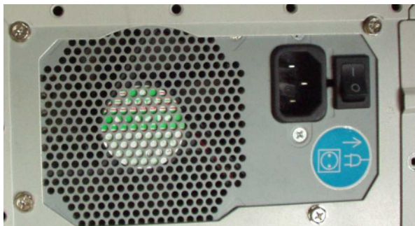
Abbildung 20: Netzteil mit Schalter, Stecker für das Netzkabel und Lufteinlass
